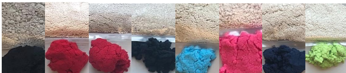
Figur 4. Prover före och efter en del av OnceMore®-processen på plagg från Elis, ett ytterligare ljusare resultat hade kunnat uppnås om hela processen undersökts.
